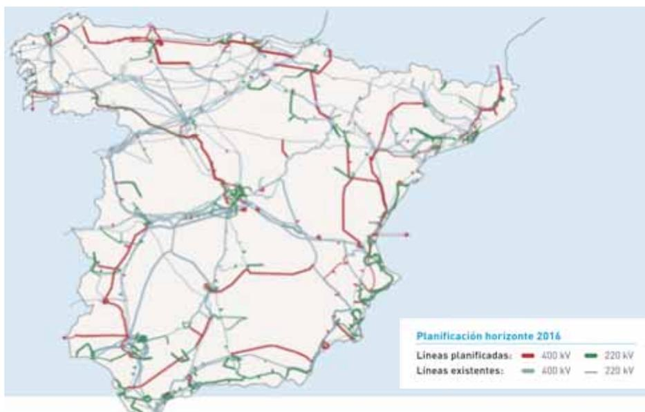
Figura 2.16. Principales líneas de transporte eléctrico existentes y programadas en el horizonte 2016.
