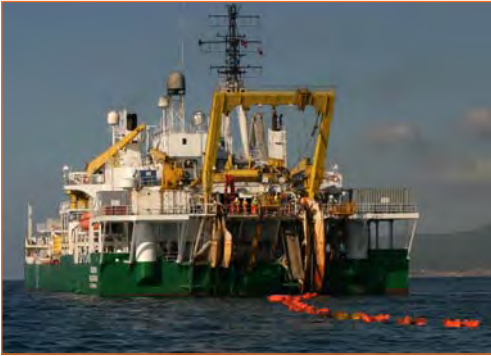
Skagerrak, barco noruego de la empresa Nexans que se dedica al tendido del cable submarino.
