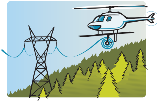
Pose d'un câble par hélicoptère.
