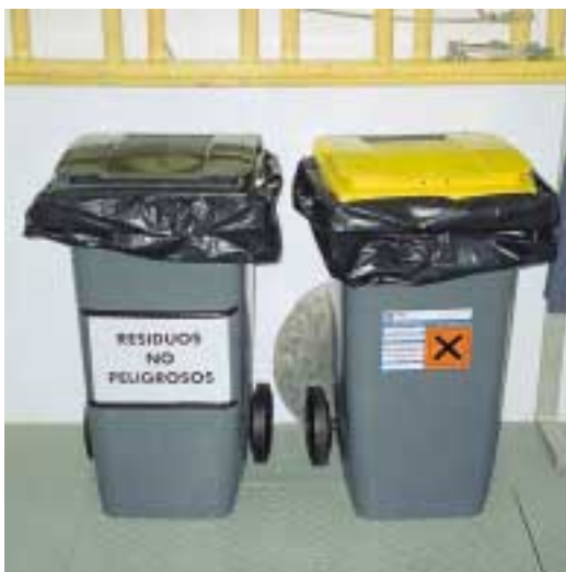
Almacenamiento de residuos: segregación de residuos peligrosos y no peligrosos
