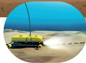
En fondos arenosos se utiliza un vehículo submarino que va soterrando los cables bajo el lecho marino mediante chorros de agua a presión. En los fondos rocosos se ejecuta una zanja mediante un robot submarino que posteriormente se recubre con los materiales extraídos.
